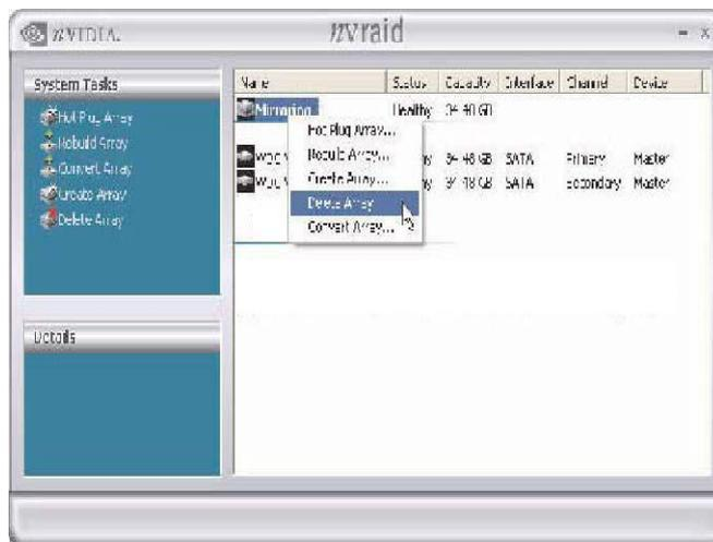
La precedente schermata mostra un mirrored array da eliminare. Dopo aver selezionato "Delete Array..." (Elimina array...), appare la seguente schermata.
