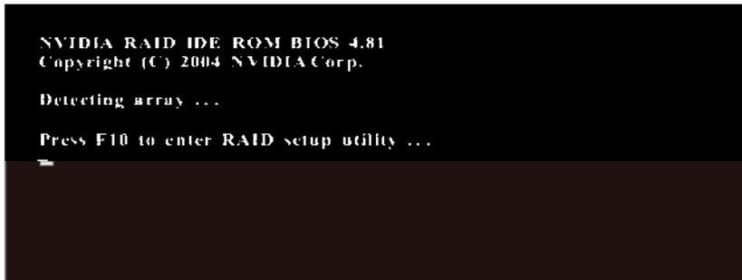
Dopo aver riavviato il sistema, attendere finché non appare il software RAID che indica di premere <F10>. Appare la finestra RAID come parte del sistema POST che avvia il processo prima di caricare il sistema operativo. Si ha a disposizione solo qualche secondo per premere <F10> prima che scompaia la finestra.
