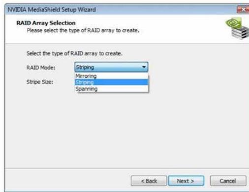
Allora, selezioni il tipo dell'allineamento di RAID per generare. Prima dovete scegliere il modo di RAID e scattarsi NEXT. Qui prendiamo Striscia (RAID 0) per esempio a permostrarvi come usare l'Immagazzinaggio per generare lo Striscia (RAID 0). Se progettate usare l'Immagazzinaggio per generare altri allineamenti di RAID, le procedure di funzionamento sono simili ai punti di generazione dello Striscia (RAID 0).
